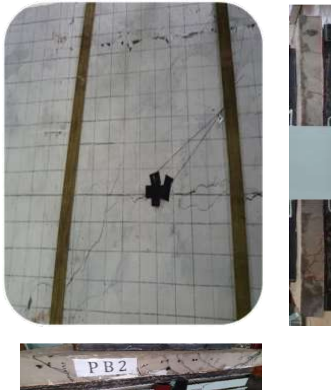
Gambar 54. Pola Retak Pada Pelat Berongga (PB-2)
