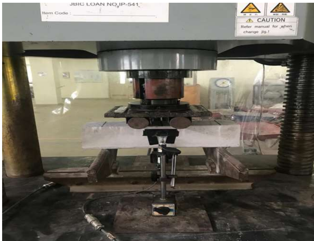
Gambar 45. Uji Kuat Lentur Balok Beton
