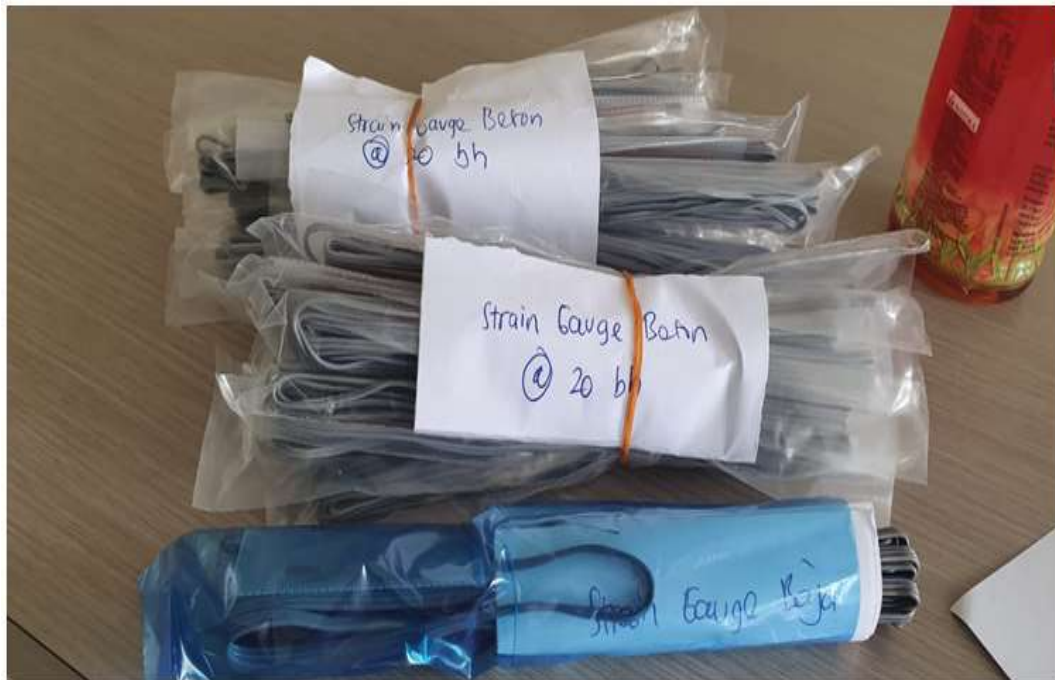
Gambar 39. Strain Gauge Baja dan Beton
