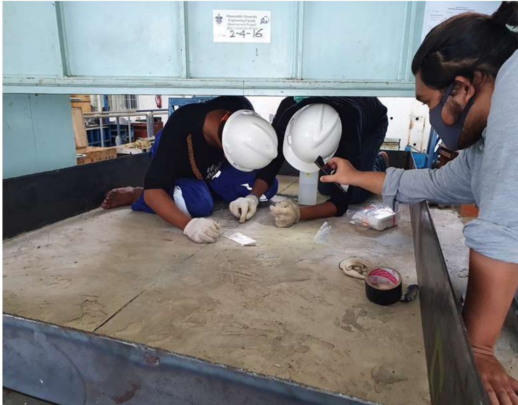
Gambar 48. Pemasangan Strain Gauge Beton
