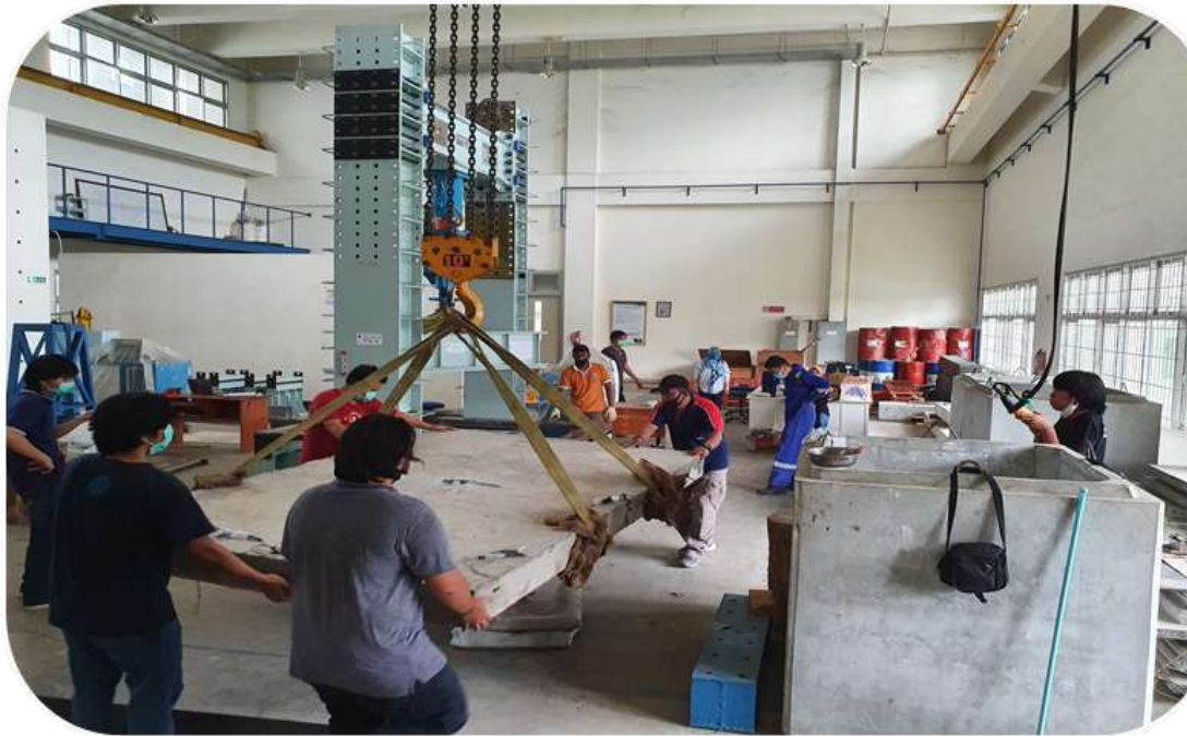
Gambar 46. Pengangkatan Benda Uji
