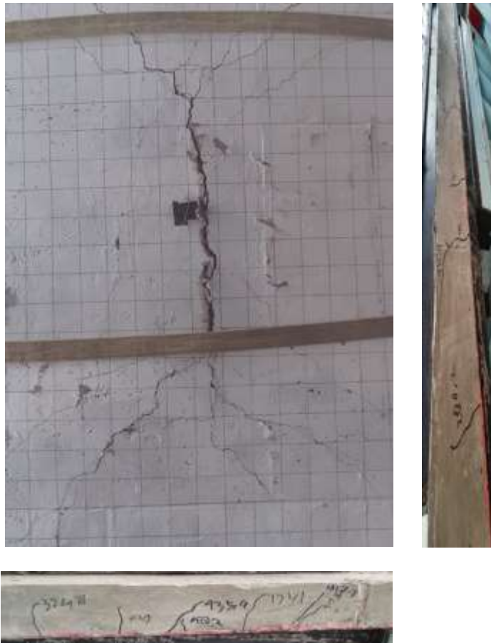
Gambar 53. Pola Retak pada Pelat Pejal (PP-1)
