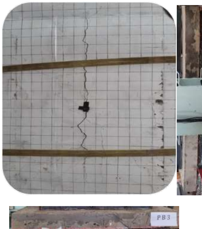
Gambar 55. Pola Retak Pada Pelat Berongga (PB-3)
