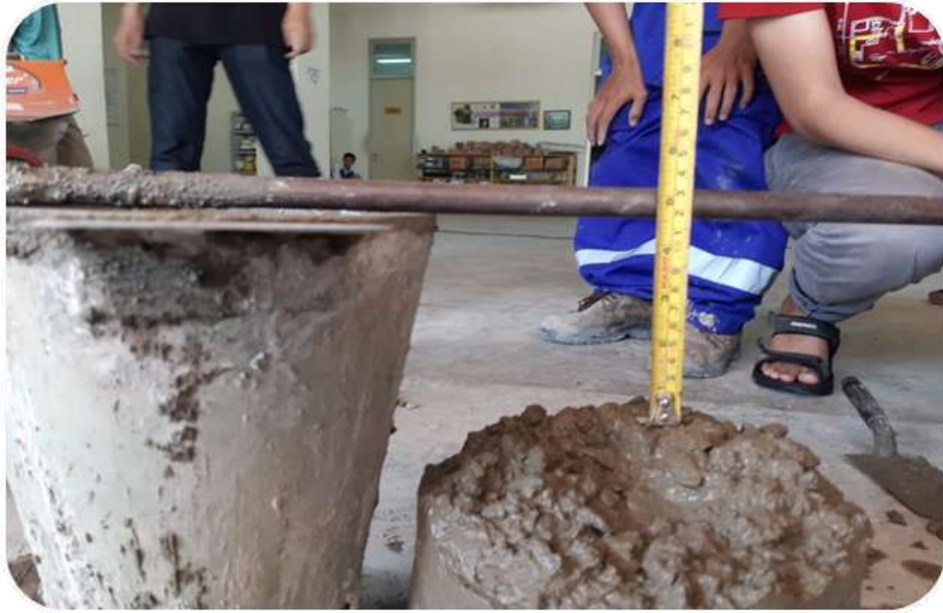
Gambar 42. Uji Slump Test
