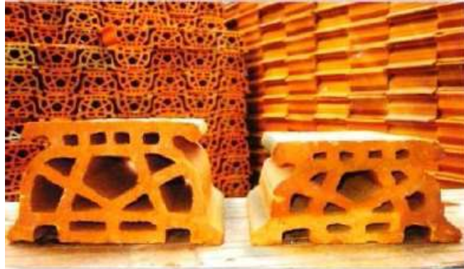
Gambar 3. Penampang Pelat Keramik Beton
