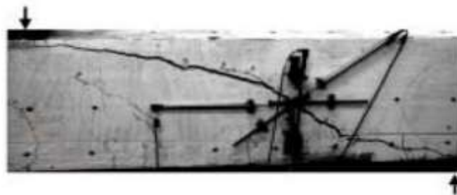
Gambar 24. Retak pada Pelat BD 450-V3 (Aldejohann dan Schnellenbach, 2003)
