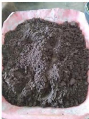
**Gambar 12.** Agregat Halus (pasir)
