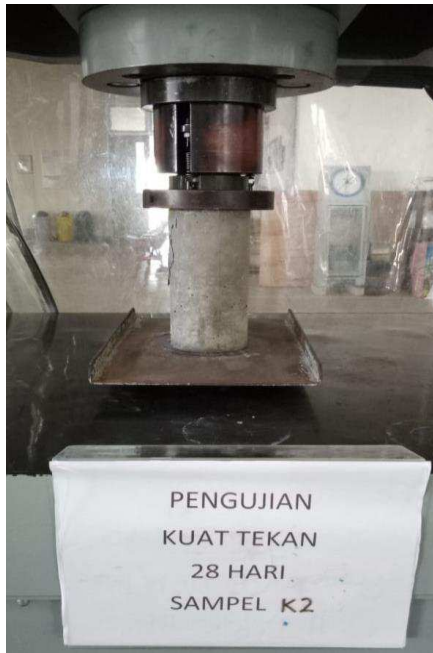
Pengujian Kuat Tekan Beton
