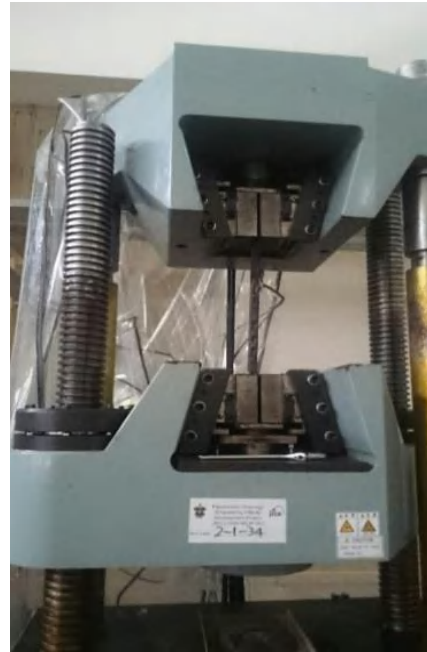
Pengujian Kuat Tarik Baja Tulangan
