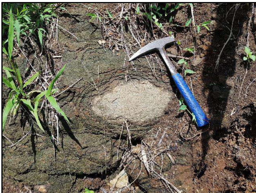
Gambar 2.3 Pelapukan kimia berupa spheroidal weathering pada litologi tufa stasiun 17 arah foto N 282°E
