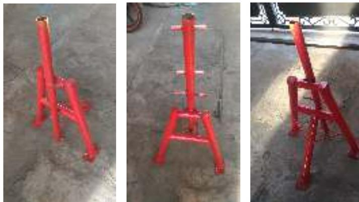
Gambar 3. Alat Pencabut Singkong Mekanis Hasil Rancangan (Sapta Asmal 2019)
