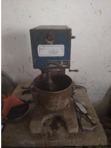
Pencampuran bahan-bahan penyusun mortar dengan menggunakan *mixer*
