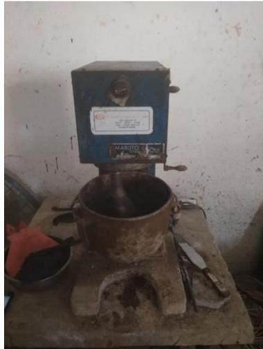
Pencampuran bahan-bahan penyusun mortar dengan menggunakan *mixer*
