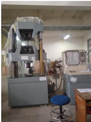
Setelah mencapai umur 28 hari mortar maka dilakukan pengujian kuat tekan mesin *Universal Testing Machine (Tokyo Testing Machine Inc.)* kapasitas 1000 kN
