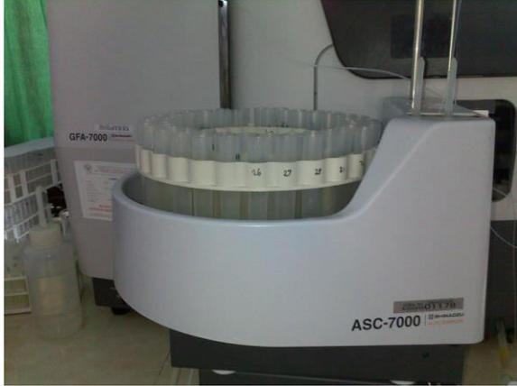
Pengujian *leached* dengan menggunakan alat *Atomic Absorption Spectrometry (AAS)*
