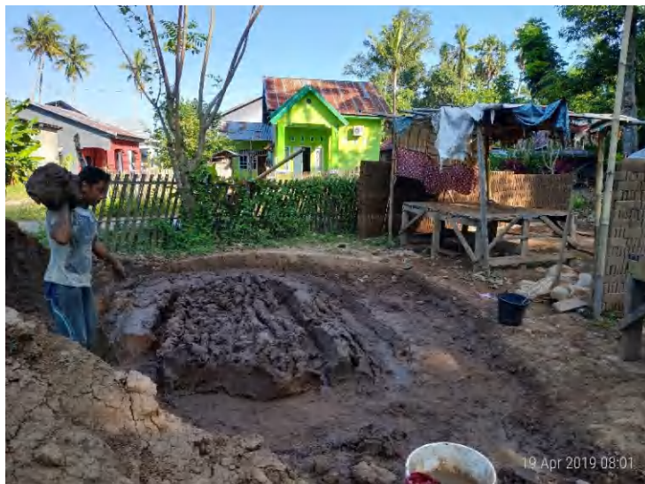
Gambar 6. Adonan Batu Bata siap dicetak Sumber: Data Primer, 2019
