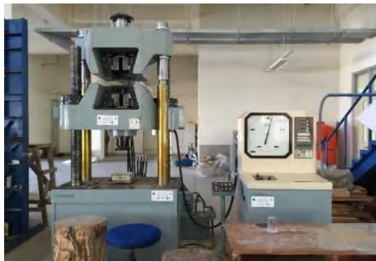
Pengujian kuat tekan menggunakan mesin Universal Testing Machine (Tokyo Testing Machine Inc.) kapasitas 1000 kN.
