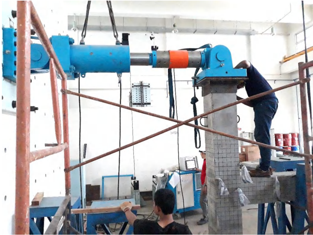
Pemasangan Actuator ke Sampel Pengujian
