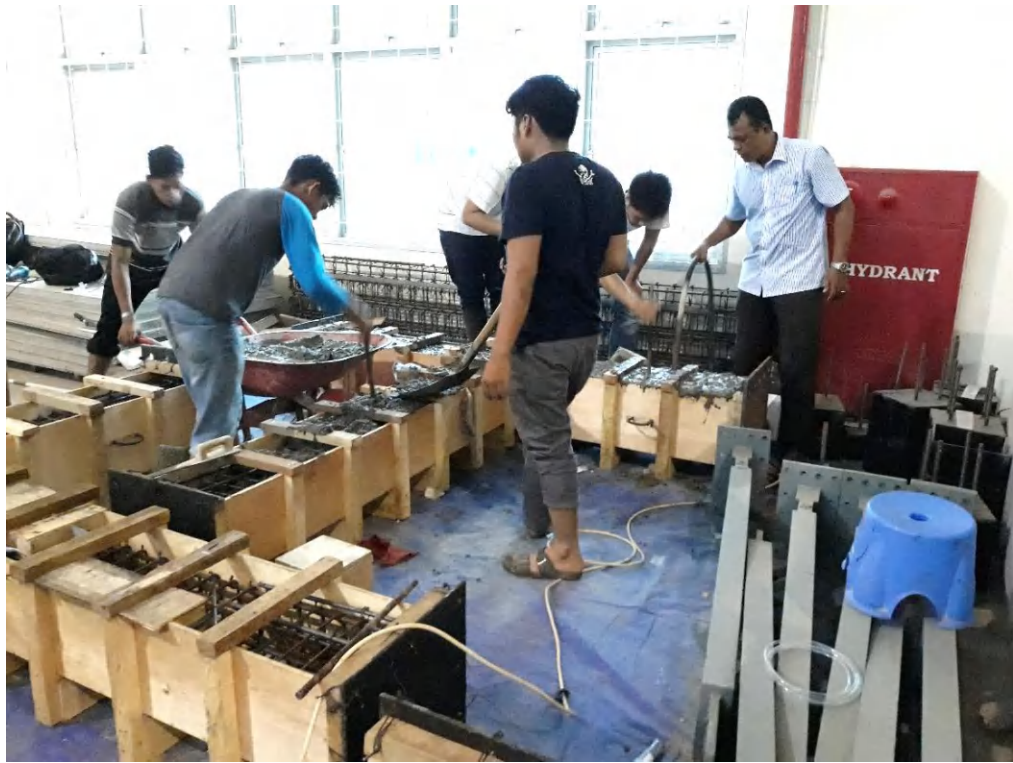
Pengecoran Sampel Monolit
