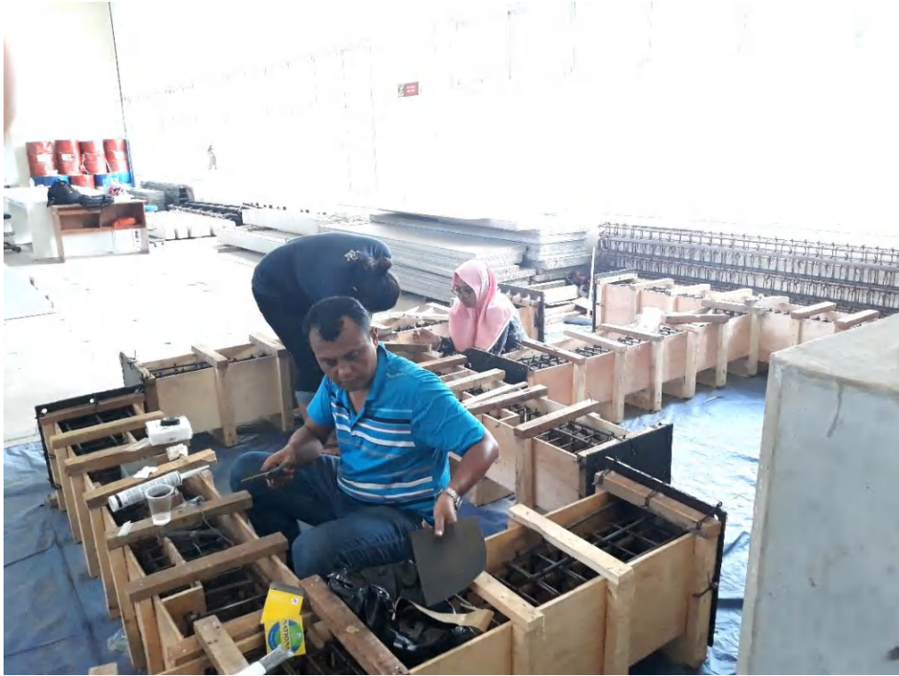
Pemasangan Strain Gauge Sampel Takikan Rangkap I
