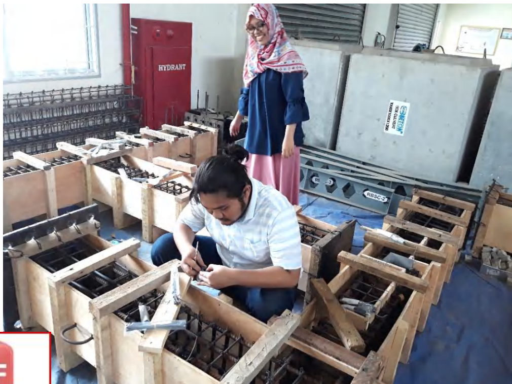
Pemasangan Strain Gauge Sampel Takikan Rangkap II
