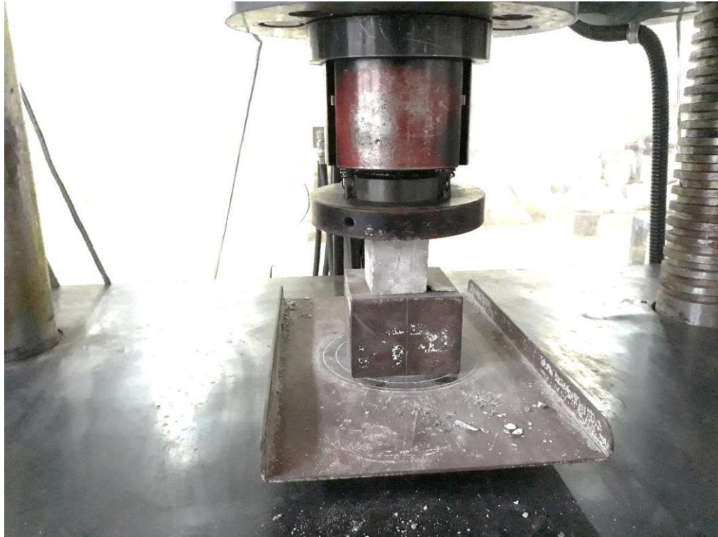
Pengujian Kuat Tekan Mortar
