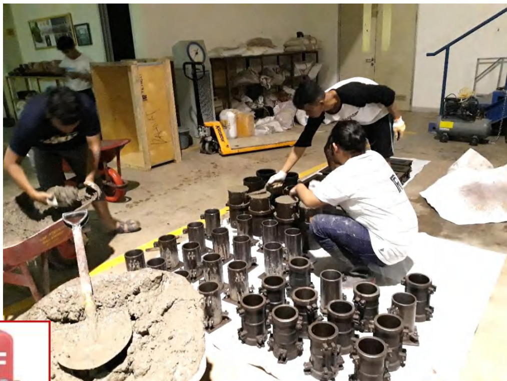
Pengecoran Sampel Uji Beton
