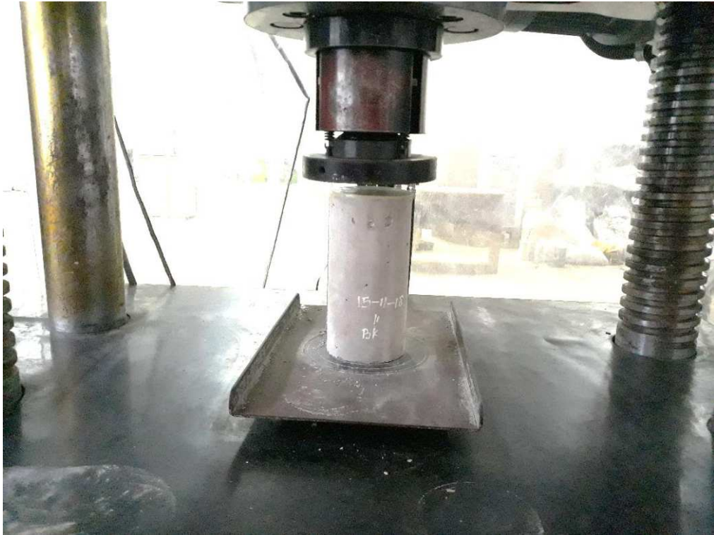
Pengujian Kuat Tekan Beton
