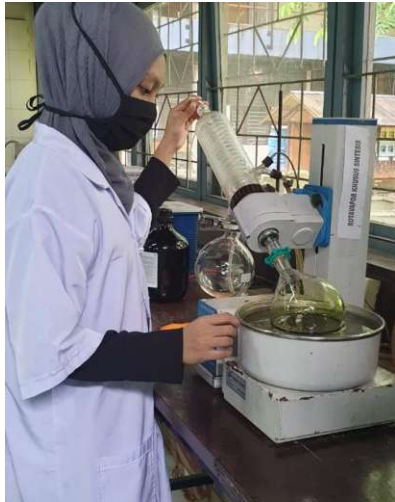
Gambar 7. Filtrat daun tanaman putri malu dimasukkan ke dalam vacuum rotary evaporator
