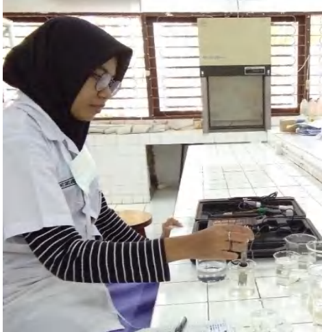
c. Penyaringan sampel air untuk analisis klorofil-a menggunakan kertas saring, pompa vacum, corong Buchner dan Erlenmeyer Buchner
