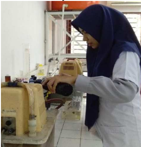
c. Penyaringan sampel air untuk analisis klorofil-a menggunakan kertas saring, pompa vacum, corong Buchner dan Erlenmeyer Buchner
