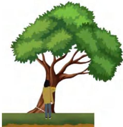
Pohon miring: DBH diukur 1,3 m dari permukaan tanah terdekat, atau searah kemiringan pohon
