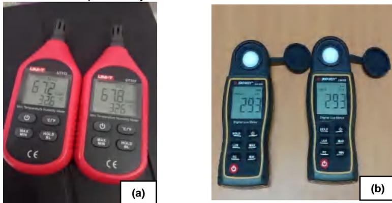
Gambar 6. (a) Uni T Alat ukur suhu dan (b) Lux Meter alat ukur pencahayaan
