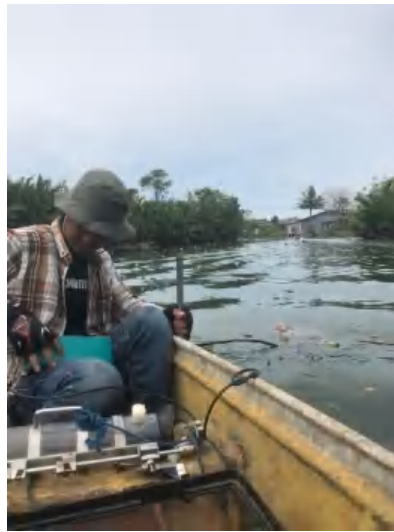
Mengukur arus dengan Current Meter
