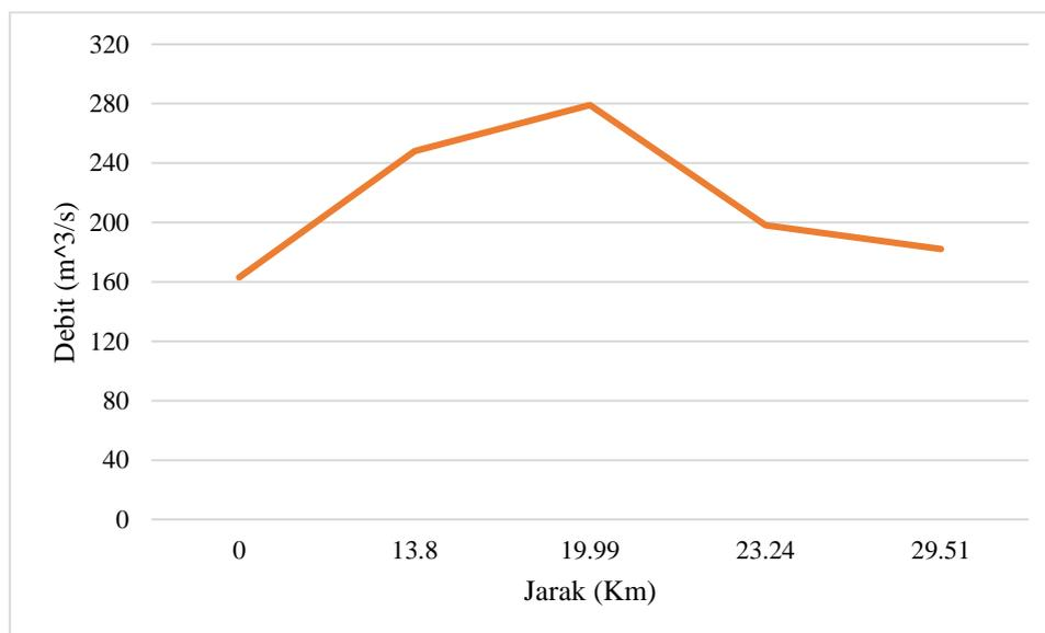
**Gambar 19** Pengukuran debit eksisting Sungai Jeneberang bagian hilir pada bulan November 2022
