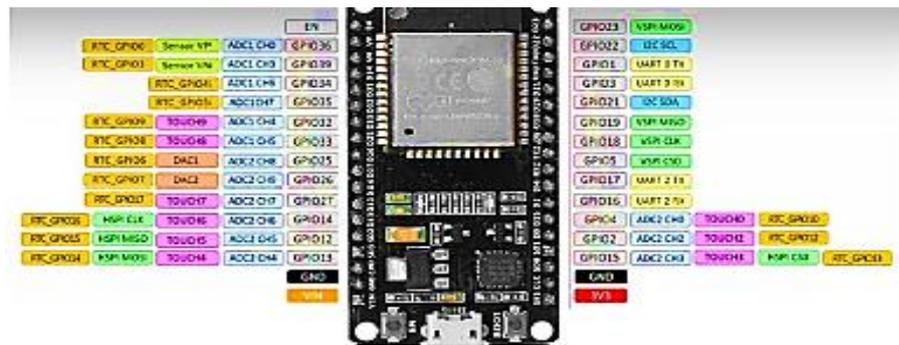
**Gambar 6** Model ESP32 dan koneksi PIN penghubung ke sensor cabang lainnya (ditunjukkan oleh berbagai kotak warna) (Triadi *et al.*, 2023)
