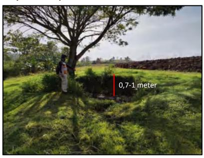
Gambar 19 Kenampakan *residual soil* yang mempunyai ketebalan 0,7 - 1 meter di sekitar stasiun 7 difoto relatif kearah N 12°E daerah Salo Baco, Kecamatan Patimpeng
