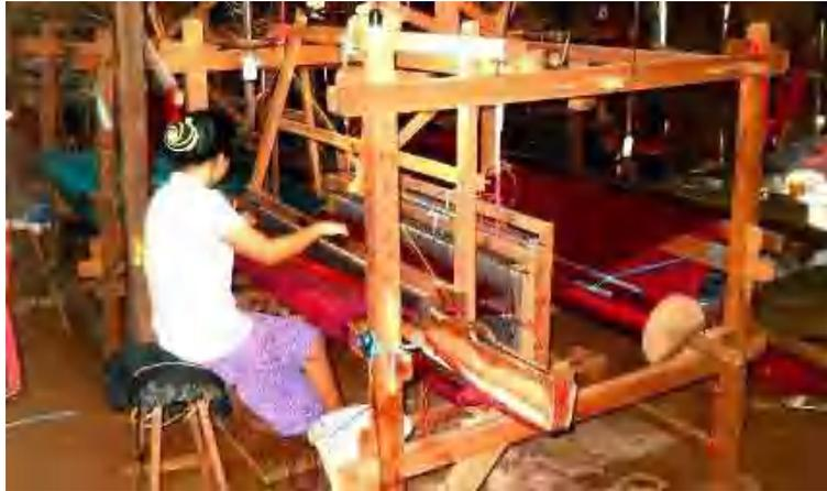
**Gambar 2. 2** Alat Tenun Bukan Mesin
