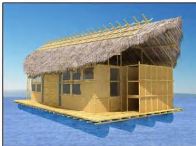
**Gambar 2. 24** Bangunan Apung dengan *platform* Bambu
