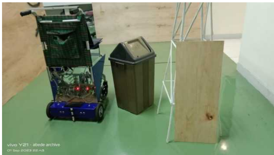
Pengujian robot melakukan pivot dalam menghindari obstacle
