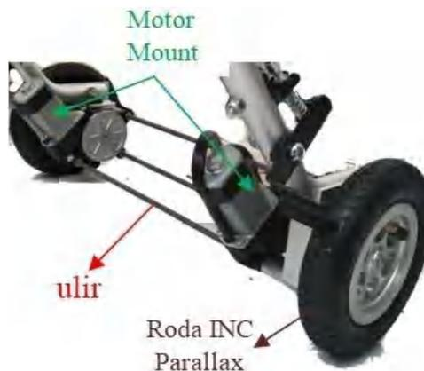
Gambar 11 Contoh komponen aktuator
