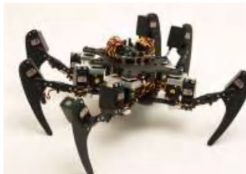
Gambar 2 Mobile Robot Berkaki
