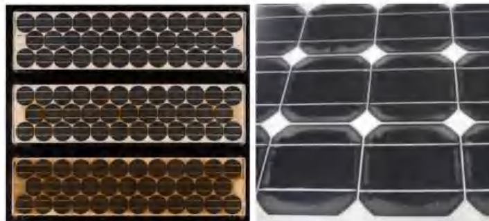
ir 4. Perubahan warna dan delemansi pada panel surya (Köntges, 1972)
