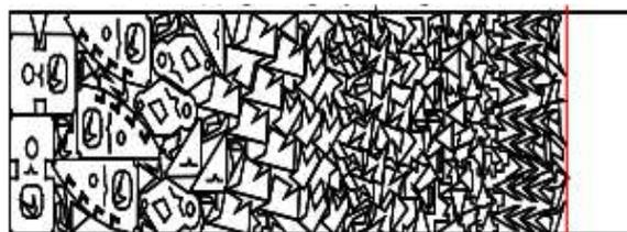
Gambar 27 Nesting Plan Menggunakan Metode Heuristic dengan Memperhatikan Sudut Tata Letak Pola Tidak Beraturan
