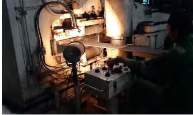
*Gambar 11 Fabrikasi Komponen Profile Datar Menjadi Kurva Dengan Pendekatan Group Technology
