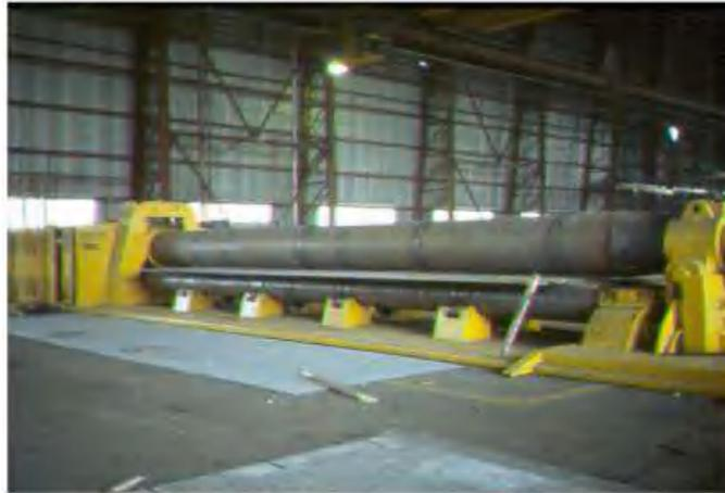
*Gambar 12 Fabrikasi Komponen Pelat Menjadi Bentuk Pipa Dengan Pendekatan Group Technology
