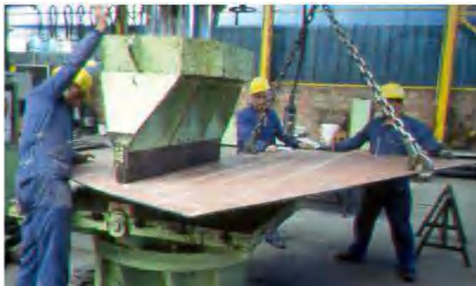
*Gambar 13 Fabrikasi Komponen Pelat Menjadi Bentuk Kurva Menggunakan Mesin Bending
