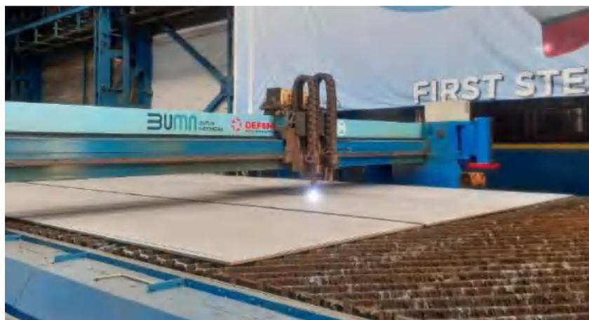
Gambar 10 Fabrikasi Komponen Pelat Berbentuk Datar Beraturan Dengan Pendekatan Group Technology
