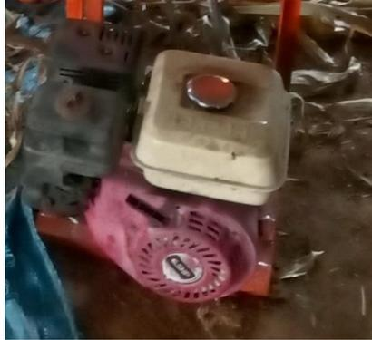
Gambar 10. Mesin bensin berkapasitas 6,5 HP
