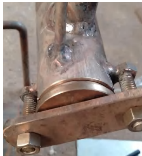
Gambar 4 Mengkunci tabung sampel
