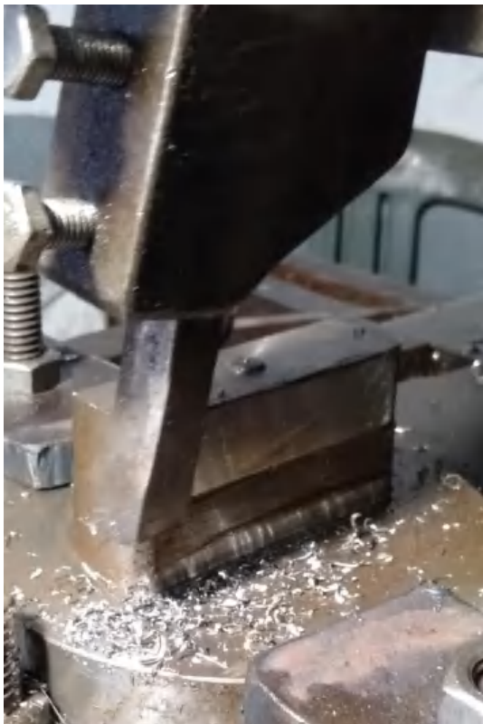
Gambar 7 Skrap bagian pinggir sampel
