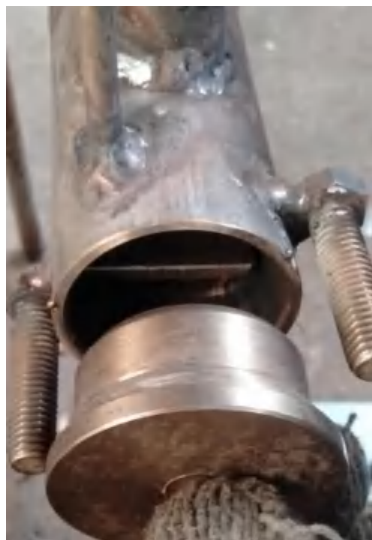
Gambar 3 Menutup tabung sampel
