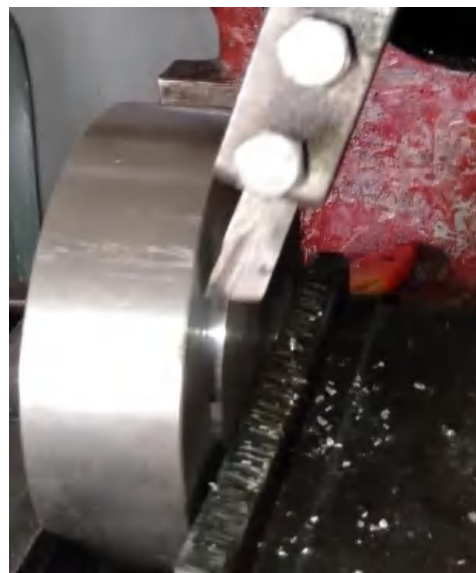
Gambar 4 Skrap dudukan cetakan sampel
