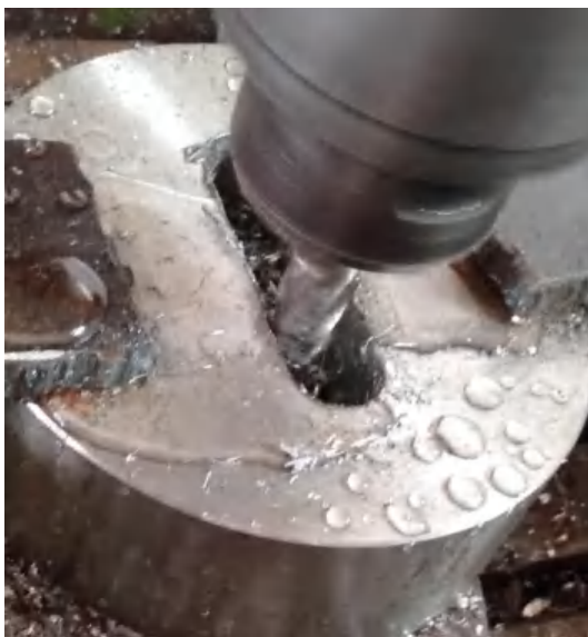
Gambar 3 Pengeboran sampai membentuk ukuran sampel
