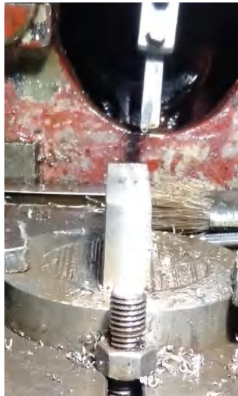
Gambar 8 Skrap bagian pinggir sampel
