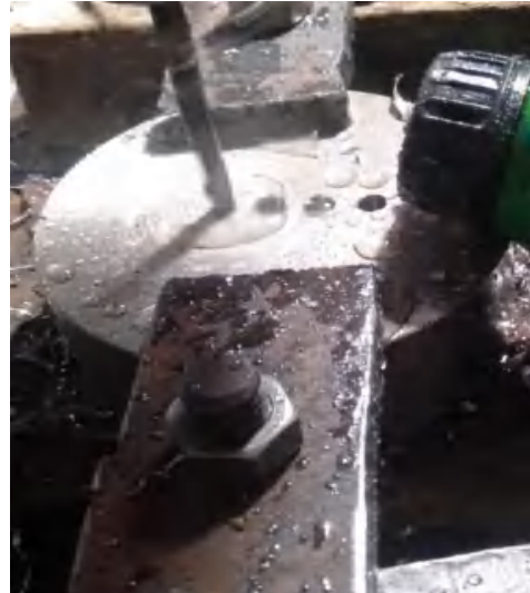
Gambar 2 Pengeboran awal untuk menandai batas ukuran sampel
