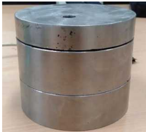
Gambar 11 Cetakan sampel saat di satukan
