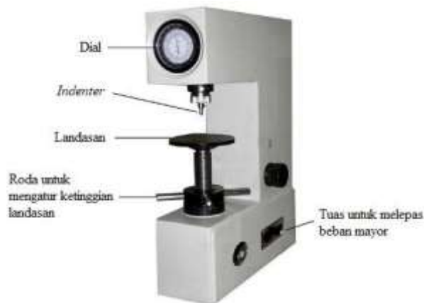
Gambar 19. Mesin uji kekerasan rockwell
