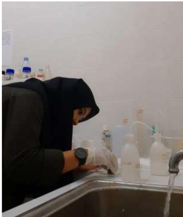
Gambar B.2 Proses etsa permukaan material sebelum proses metalografi
