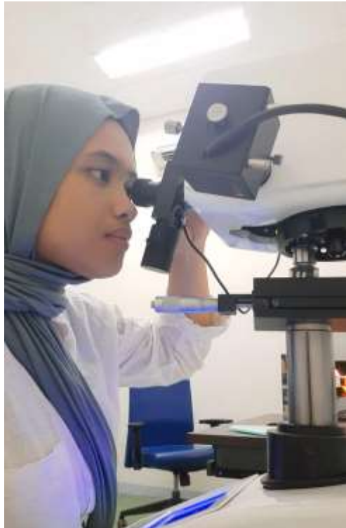
Gambar B.3 Proses pengujian kekerasan baja karbon tinggi (JIS G 3506)
