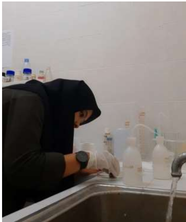
Gambar B.2 Proses etsa permukaan material sebelum proses metalografi
