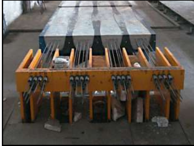
Gambar 17 Tiang pancang beton pratekan
