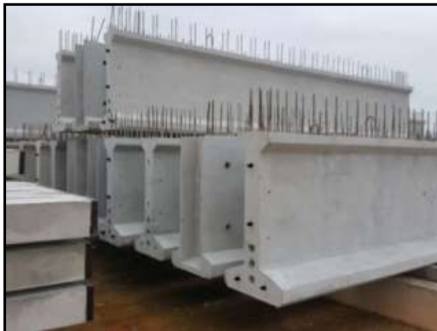
Gambar 16 Jembatan beton pratekan
