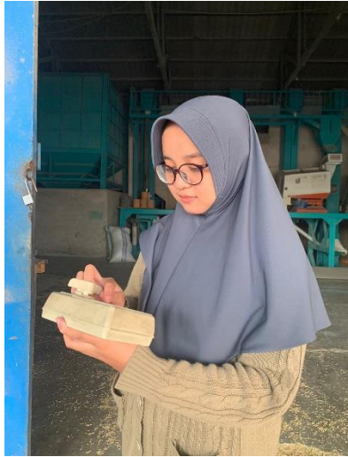
Pengukuran Kadar Air Gabah
