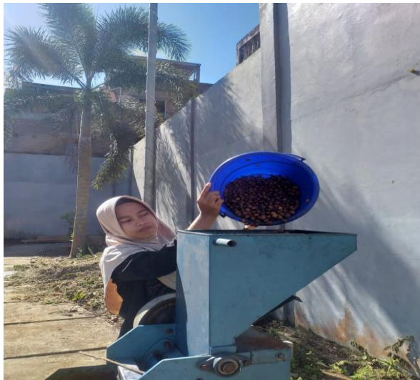
Gambar 24. Pengupasan kulit daging buah menggunakan pulper
