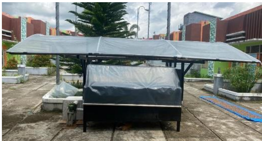
Gambar 27. Mesin pengering tipe bed dryer
