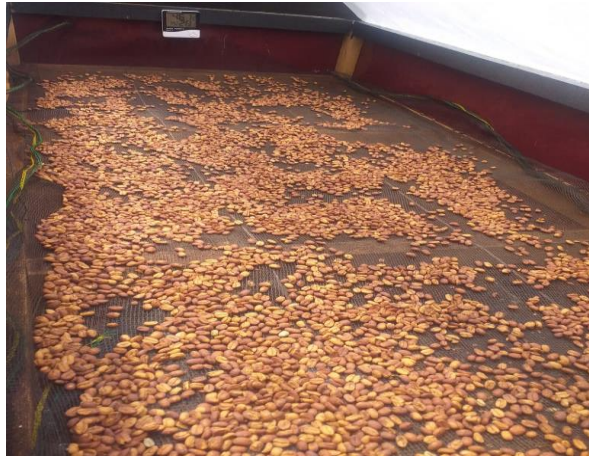
Gambar 26. Proses pengeringan biji kopi arabika dengan mesin tipe bed dryer
