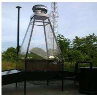
Gambar 3. Pengering surya tipe bak
