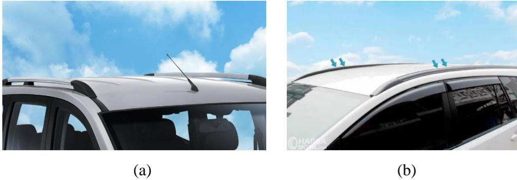
Gambar 4 (a) *roof rails* tipe menyerupai huruf “C” terbalik, (b) *roof rails* tipe flush-mounted pada kendaraan. (Wuling.id, 2020)
