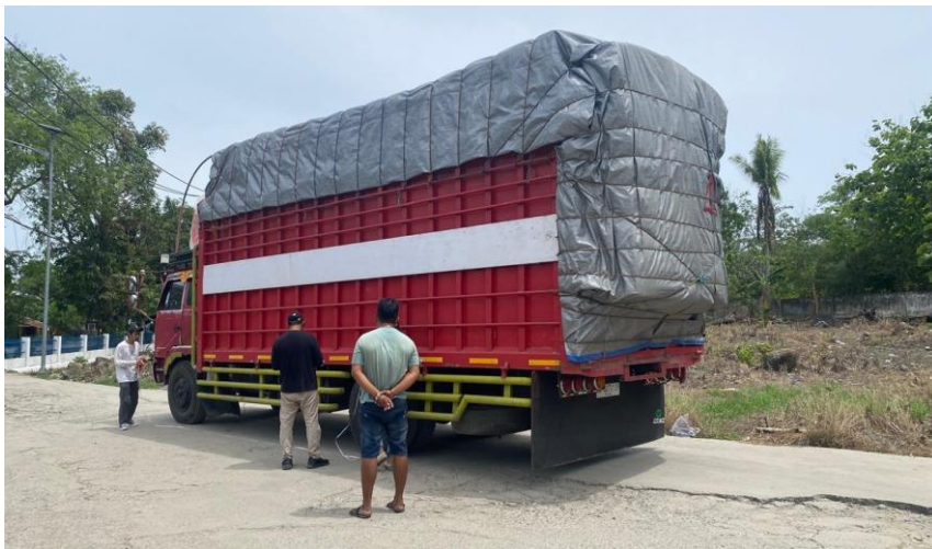
Gambar 4. Pengukuran Dimensi Kendaraan Angkutan Barang Sumbu 1.2
