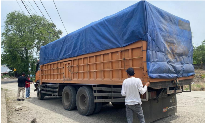
Gambar 5. Pengukuran Dimensi Kendaraan Angkutan Barang Sumbu 1.22
