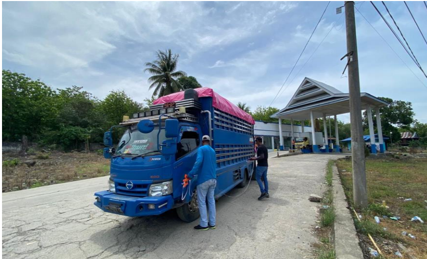
Gambar 3. Pengukuran Dimensi Kendaraan Angkutan Barang Sumbu 1.1
