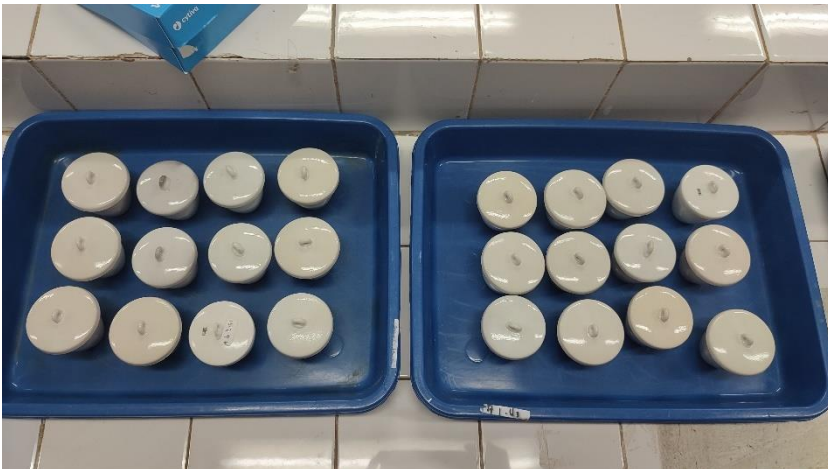
Dokumentasi 10. Cawan porselin berisi sampel sedimen yang telah diproses dalam tanur untuk menghilangkan bahan organik melalui proses pembakaran.
