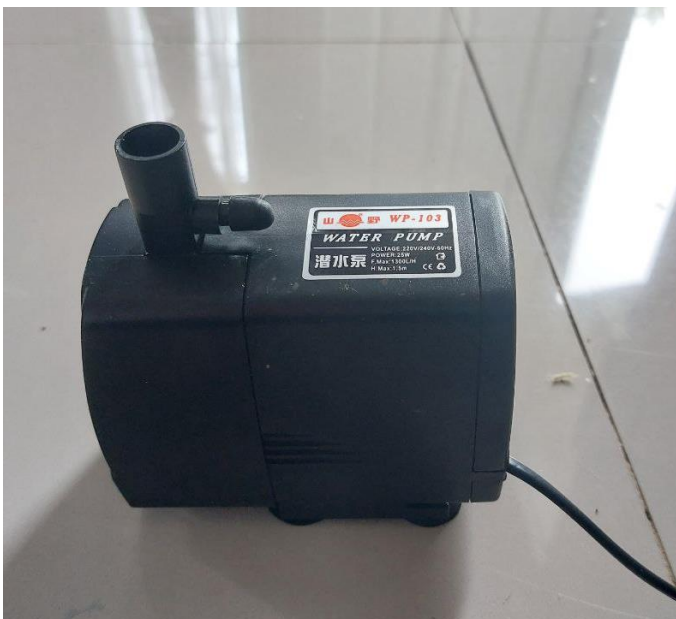
Pompa Air Agar Bisa Mengalirkan Air Ke Pipa Hidroponik
