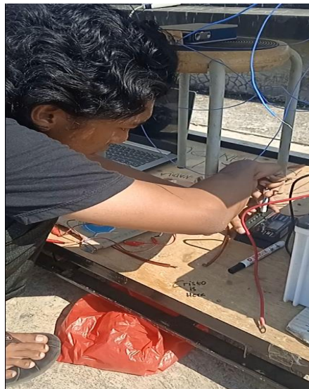
Lampiran 6 Penyambungan kabel dari panel surya ke aki
