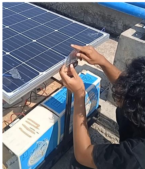
Lampiran 9 Pengaturan variasi kemiringan panel surya
