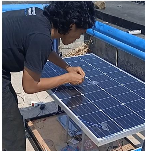
Lampiran 8 Pemasangan Termokopel
