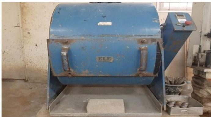
**Gambar 11.** Pengujian Keausan Agregat Dengan Mesin Abrasi Los Angeles
