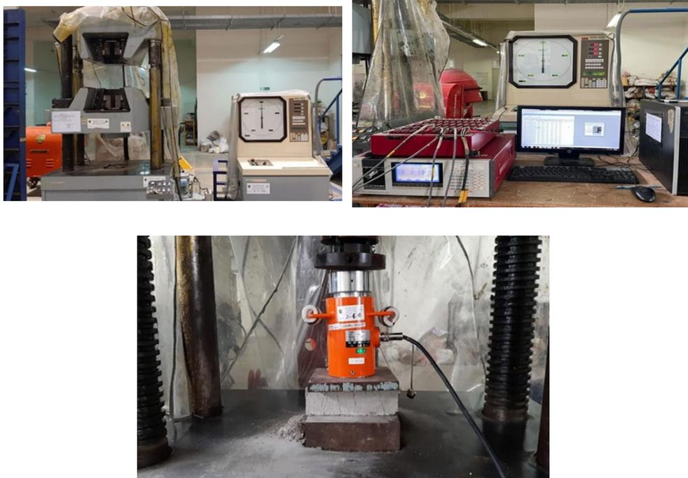
**Gambar 8.** Pengujian Kuat Tekan Paving Blok
