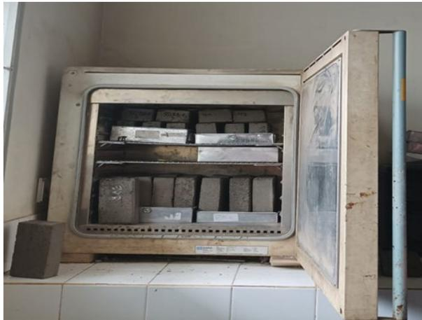
**Gambar 9.** Pengujian Penyerapan Air Paving Block
