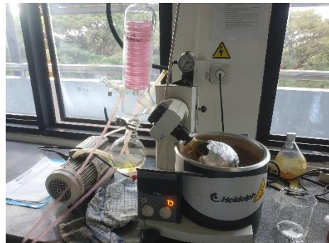
Gambar 13. Penguapan pelarut dengan rotary evaporator
