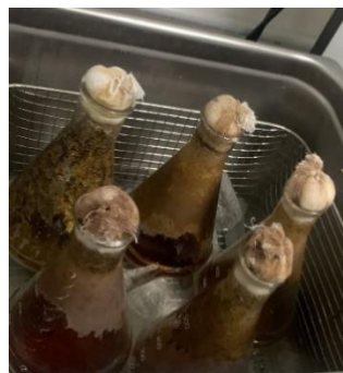
Gambar 11. Proses sonikasi hasil fermentasi
