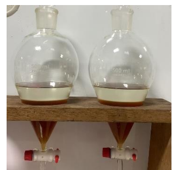
Gambar 12. Proses ekstraksi hasil fermentasi
