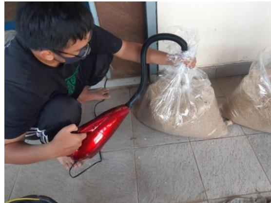
Gambar 4. Proses Pengemasan Dan Penghisapan Udara
