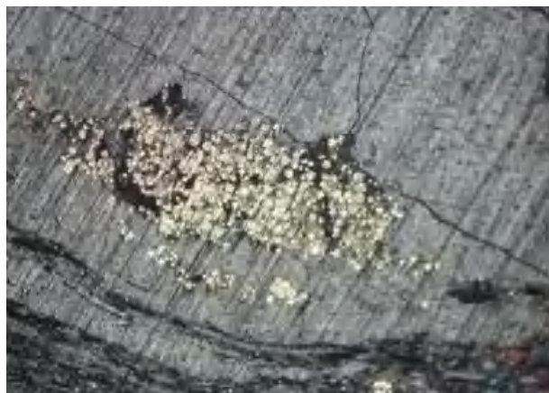
Gambar 2 Kenampakan mineral pirit hasil uji mikroskop optik pada seam batu bara (Widodo dkk., 2019)
