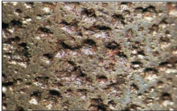
Gambar 4 Korosi Sumuran Pada Permukaan Roll Bearing
