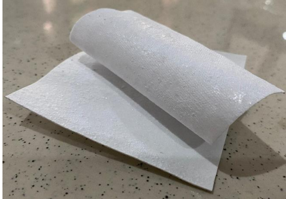
Gambar 3. Hasil Preparasi (Komposit Poliester/PVA/BaCO 3 )
