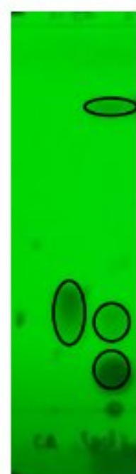
Gambar 23. Monitoring hasil evaporasi menggunakan KLT ( n -heksana : etil asetat 2 : 1) (spot kiri : asam sinamat; spot kanan : produk reaksi)
