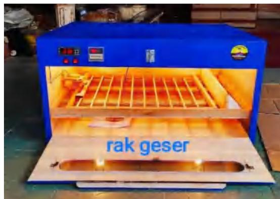
Gambar 9. Mesin Tetas Manual
