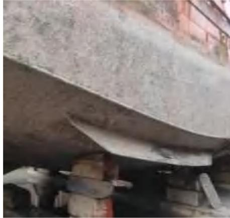
**Gambar 2.** Korosi pada pelat lambung kapal
