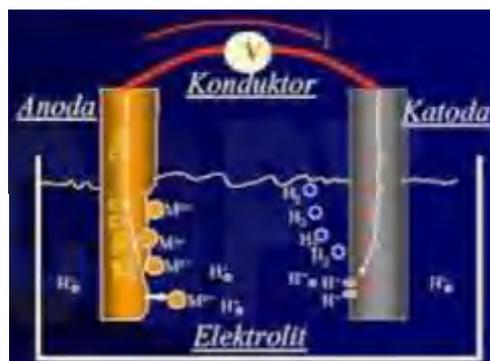
**Gambar 5.** Sel korosi basah sederhana
