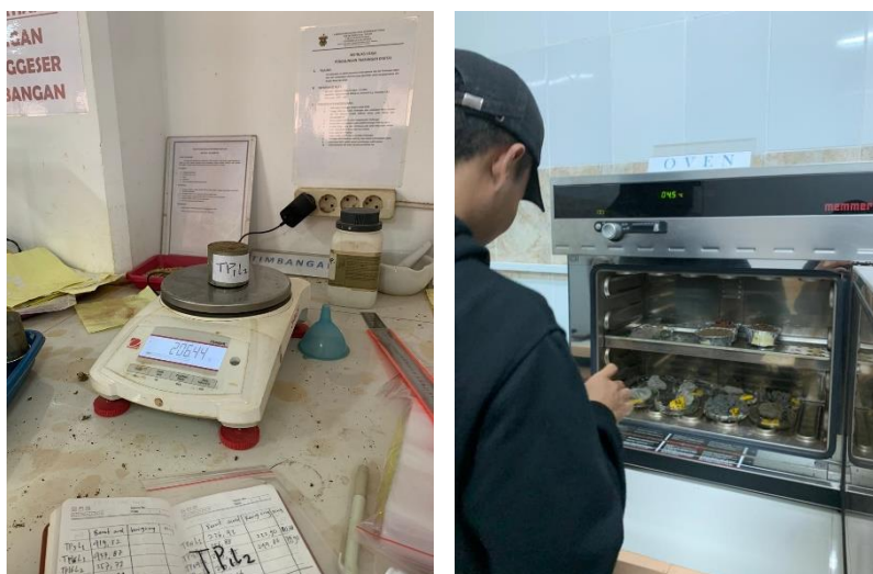
Gambar Lampiran 1. Pengukuran bulk density metode gravimetri
