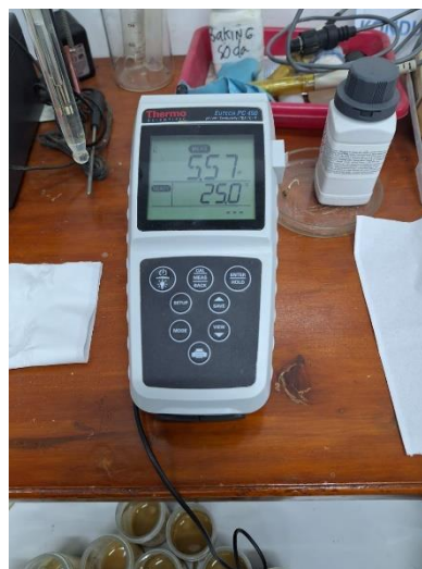
Gambar Lampiran 4. Pengukuran pH tanah dengan pH meter
