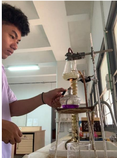
Gambar Lampiran 5. Pengukuran N-total dengan metode Kjedahl
