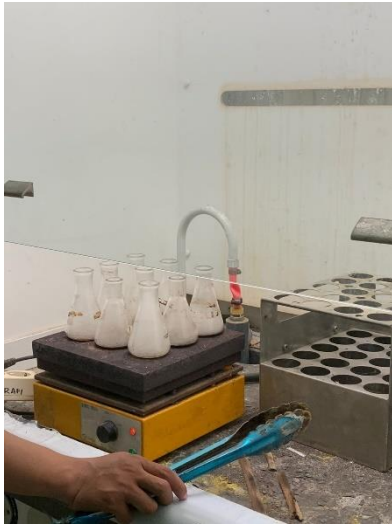
Gambar Lampiran 5. Pengukuran N-total dengan metode Kjedahl
