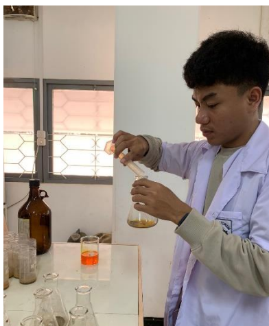
Gambar Lampiran 7. Pengukuran C-Organik dengan metode Walkey and Black
