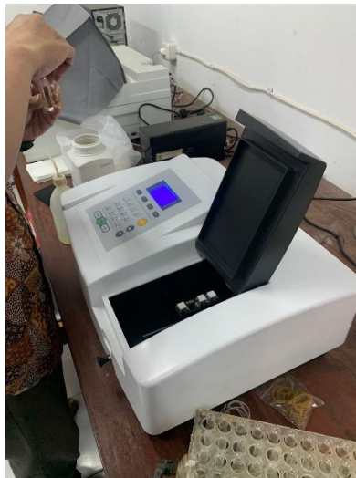
Gambar Lampiran 6. Pengukuran P-tersedia dengan metode Olsen
