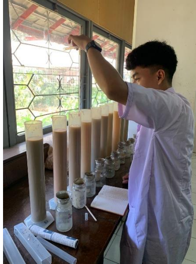
Gambar Lampiran 2. Pengukuran tekstur metode hidrometer
