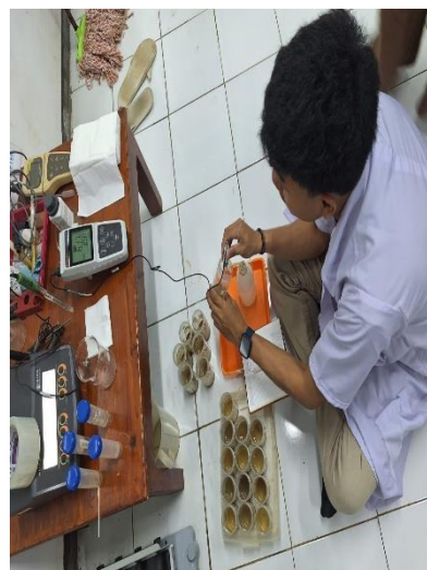
Gambar Lampiran 4. Pengukuran pH tanah dengan pH meter
