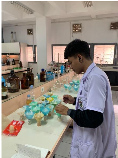
Gambar Lampiran 6. Pengukuran P-tersedia dengan metode Olsen
