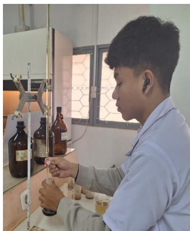
Gambar Lampiran 7. Pengukuran C-Organik dengan metode Walkey and Black
