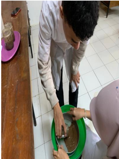
Gambar Lampiran 2. Pengukuran tekstur metode hidrometer
